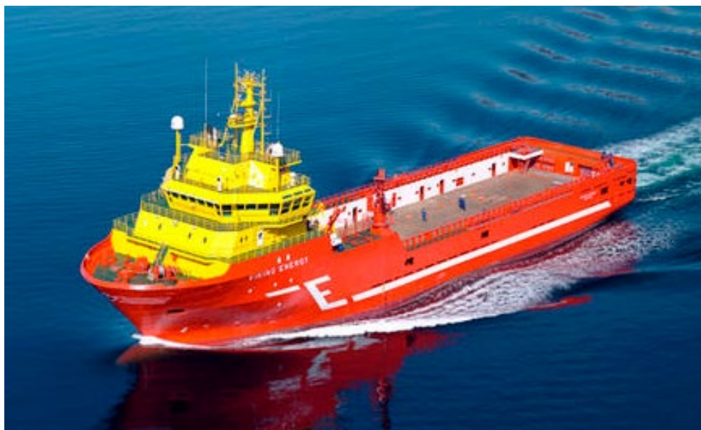
Eidesviks forsyningskip Viking Energy var første offshorefartøy med LNG- motor i 2003. I 2016 var skipet igjen først med en avansert batteriinstallasjon som per år har redusert drivstofforbruket med 17 prosent. Batterisystemet har en kapasitet på 650kWh og omformer/kraftelektronikk som gjør at det kan levere 1600kW. Foto: Eidesvik Offshore
