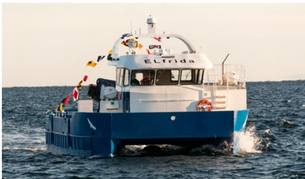
Den hybridelektriske arbeidsbåten Elfrida, ble tatt i bruk av Salmar Farming i 2017, med 80-90 prosent elektrisk drift. Foto: Enova
