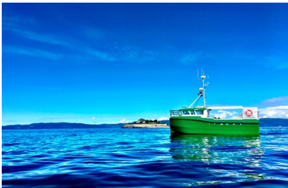
Karoline er verdens første hybridsjark med elmotor. Det snaut 11 meter lange fartøyet bruker dieselgeneratorer til og fra fiskefeltet. Batteriet forsyner skipet med nok kraft til to timer fiske og 45 minutter framdrift. Foto: SIEMENS
